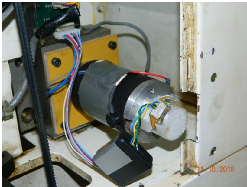
Il motore G240 per l'asse Z con encoder 100ppr (400cpr) Le scatoline nere collegate agli encoders contengono i trasmettitori differenziali
