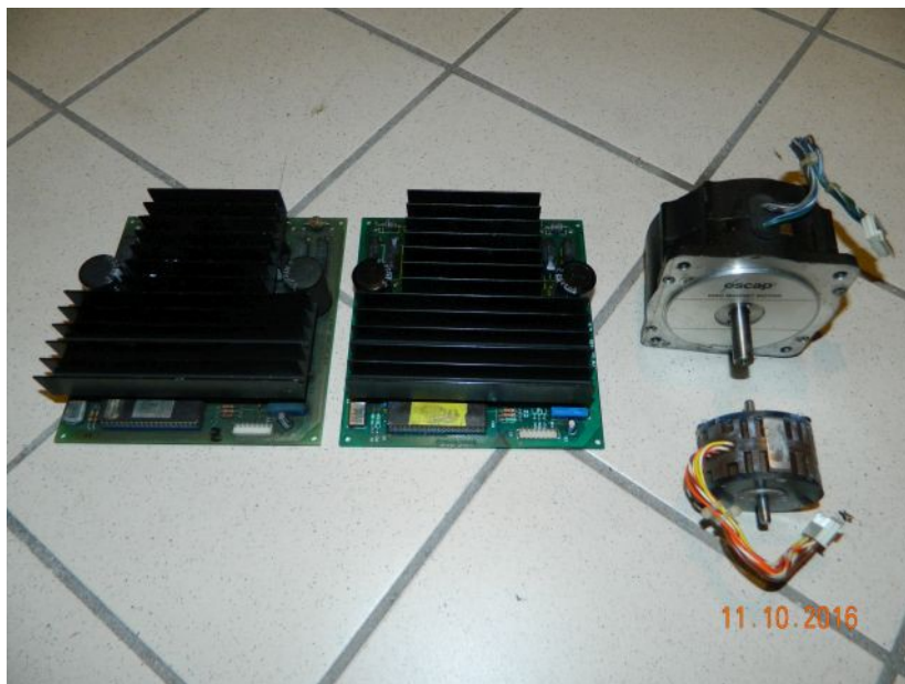
I driver e i motori stepper portescap originali
