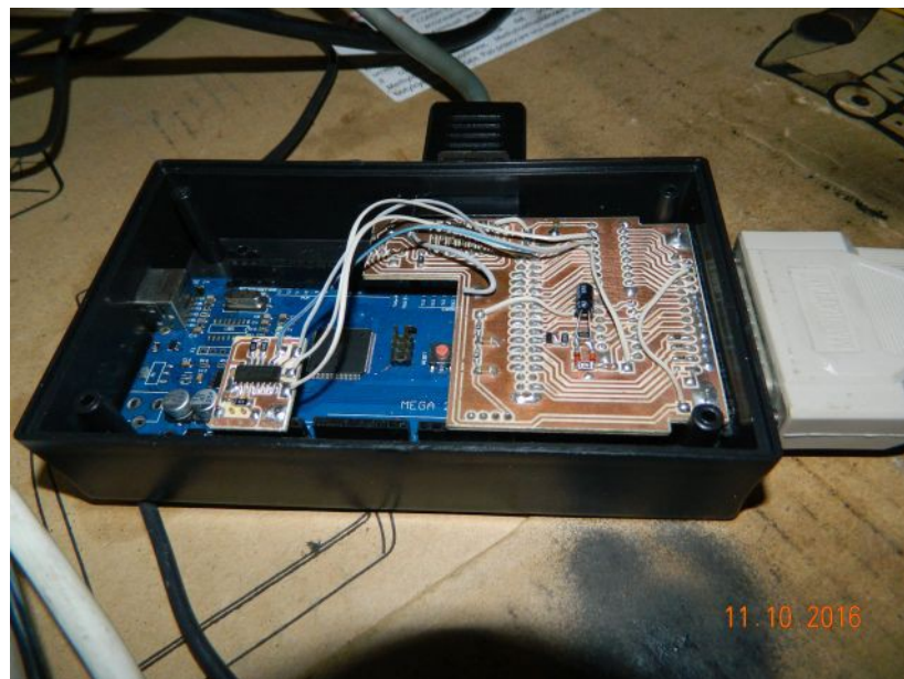
L'Interfaccia per il nuovo controller MACH3, a destra il connettore porta parallela verso il PC, viene alimentata dai 5VDC provenienti da DM3000.
